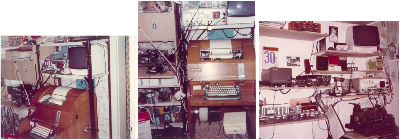
Links und Mitte: Lorentz LO15B mit Lochstreifenleser und -stanzer im Standgehäuse Rechts: Siemens T37 ohne Gehäuse, leider fehlte der Buchstabe „E“, da er mit dem ursprünglich darüberliegenden „SS“ nach dem Krieg entfernt wurde. (Quelle: eigene Aufnahmen DL5DI)
