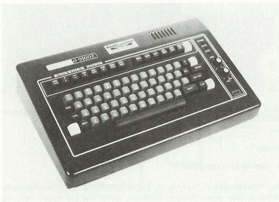
Abb. 5.3 Fernschreib- und CW-Computer kommerzieller Fertigung aus Japan (TONO 9100 E) Foto: Weberruß
