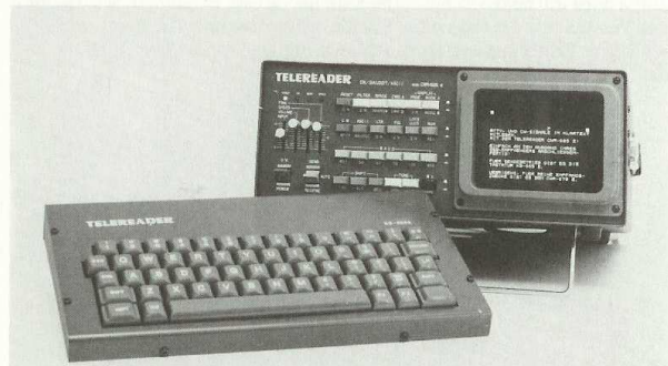
Abb. 5.5 Fernschreib- und CW-Computer mit getrennter Tastatur aus Japan (Telereader CWR 685E und KB 685E) Foto: Richter + Co.
